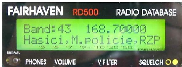
Bei Funktion „Auto Memory“ wird jeder Eintrag gespeichert und das auch mehrfach (vorteilhaft z.B. bei BC- Dxing), sobald der Squelch aktiv ist. Ein Eintrag mit Frequenz und Betriebsart wird in einer neuen Gruppe angelegt, der dann umbenannt werden kann. Unerwünschte Einträge kann man sehr
