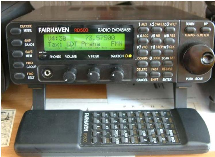
Der Fairhaven RD500 VXG präsentiert sich als hochwertiger Radioscanner und als ernstzunehmender Kurzwellenempfänger. Die Abmessungen sind ähnlich die eines Autoradios. Er empfängt Signale in einem breitem Frequenzspektrum von 10 kHz bis 1775 MHz, mit ausgezeichneter Empfindlichkeit (z.B. von 0,5 bis 500 MHz  $< 0,03 \mu\text{V}$  für SSB, oder besser als  $0,3 \mu\text{V}$  von 48 bis 860 MHz für NFM an 50 Ohm. Und das bei einem anständigem Wert von IP 3.Ordnung  $> + 10 \text{ dBm}$ . Im
