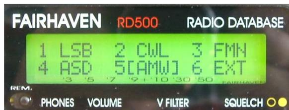
Betriebsarten FMW und FM Stereo sind nur im Bereich von 65 MHz bis 175 MHz einsetzbar. Für die Frequenzen von 45 MHz bis 855 MHz, kann man den RD500 VXG umschalten auf TV- Betriebsart, der durch den eingebauten TV-Tuner mit SW-Filter und Synchron PLL- Demodulator mit 5,5 MHz Video Offset & separater Video/Audioausgänge, Bilder auf einen Monitor bringen kann.
