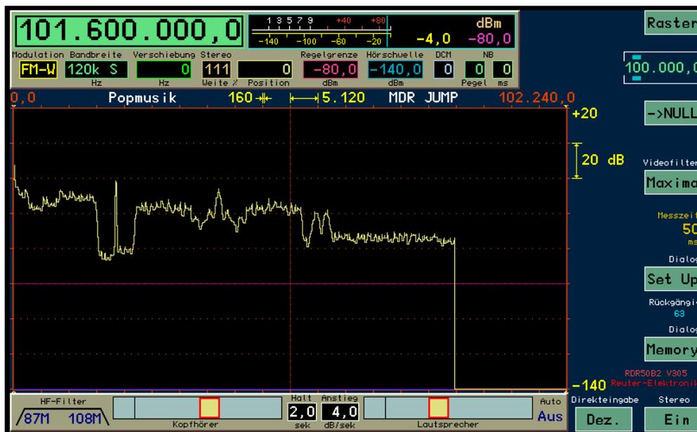
Abb. 13: Darstellung des Stereosignals beim RDR54/50, gut zu sehen der 19 kHz Stereopilot-Träger, das MPX-Signal und die RDS-Datengruppe im Bereich um 57 kHz
